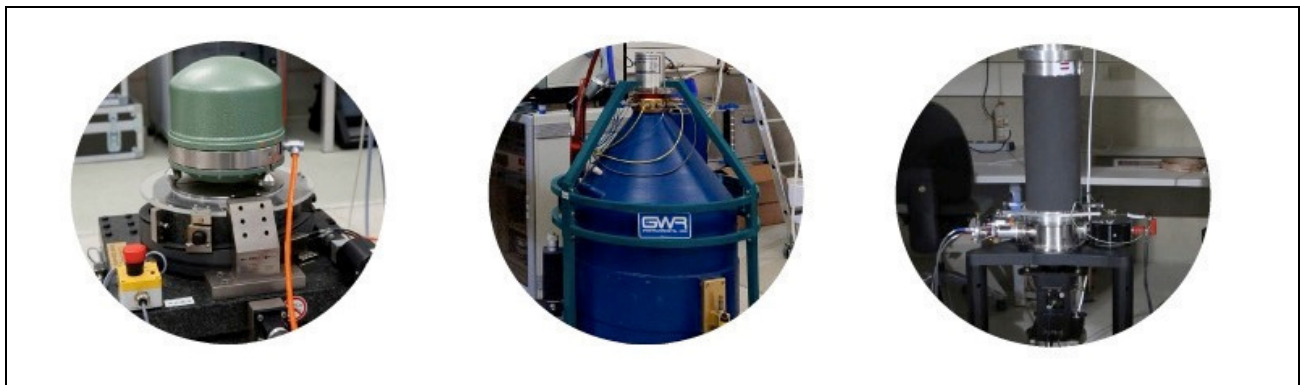
Abb.9: links: Kalibriertisch CALTAB_1, Mitte: Gezeiten Gravimeter SG GWR CO25, rechts: Absolut Gravimeter FG5
