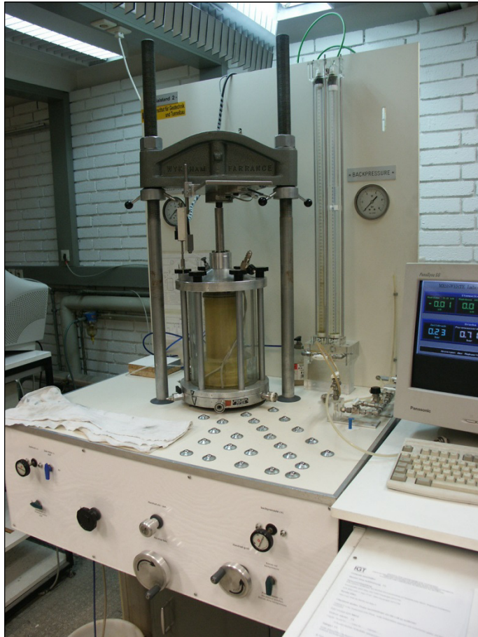
Abb. 3: Triaxialversuch, Versuchsstand und schematischer Aufbau.
