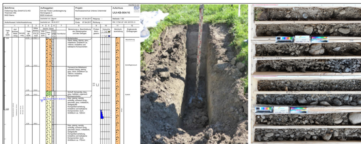
Abb. 8: Typisches Bodenprofil (Schurf, Rotationskernbohrung) aus dem Projektgebiet.
