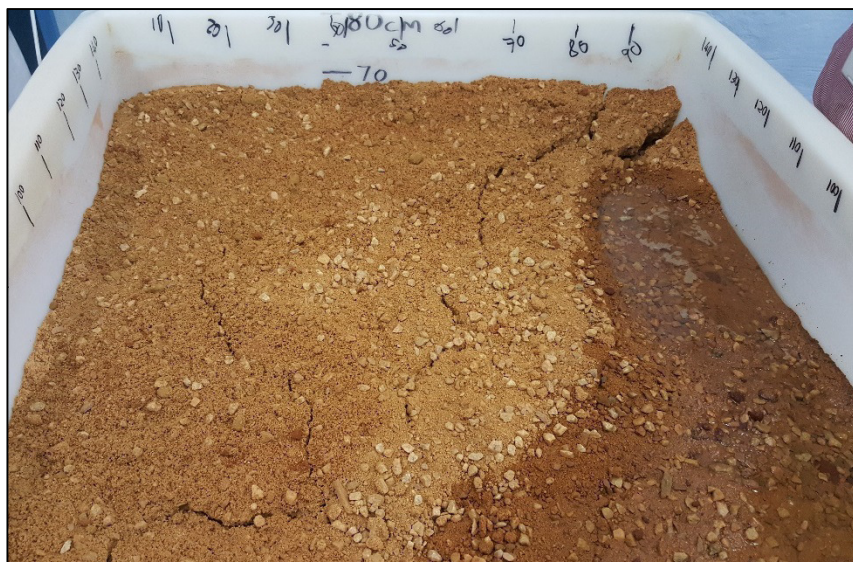
Abb. 3: Laterale Randmulde mit „See“- und Rissbildung. Zulauf im Vordergrund aus 30 cm Tiefe und Fließrichtung in den Hintergrund. Abstand der Markierungsstriche 10 cm (Foto: Wolkersdorfer).
