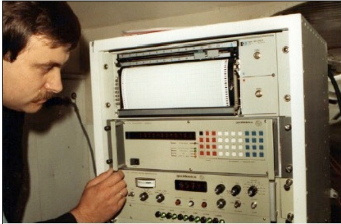
Abb.4: Protonen-Magnetometer mit digitaler und analoger Datenerfassungseinheit mit Peter Melichar im Pilatus Porter des BEV - Bundesamt für Eich und Vermessungswesen
