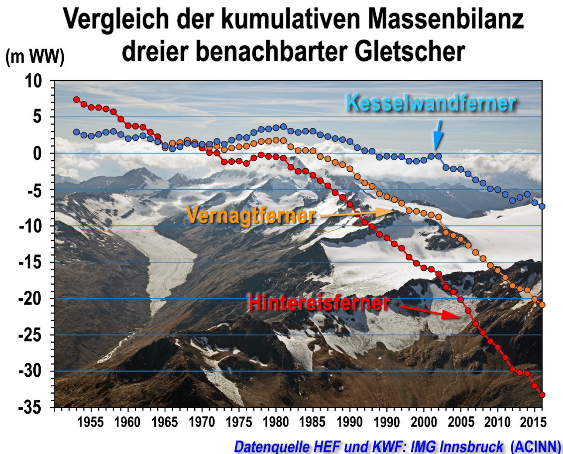
Abb. 2: Kumulative jährliche spezifische Massenbilanzen, bestimmt nach der glaziologischen Methode, für drei Gletscher im hinteren Ötztal. Die Kurven dokumentieren die jährliche mittlere Dickenänderung des Eiskörpers.
